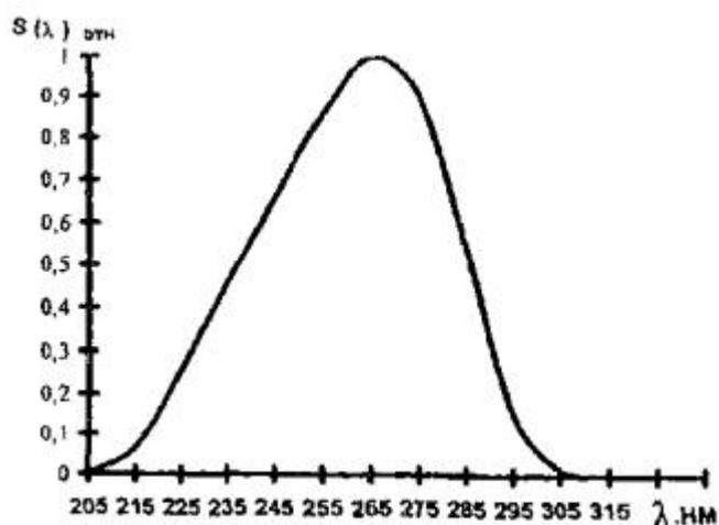
Рис.1. Кривая относительной спектральной бактерицидной эффективности ультрафиолетового излучения
